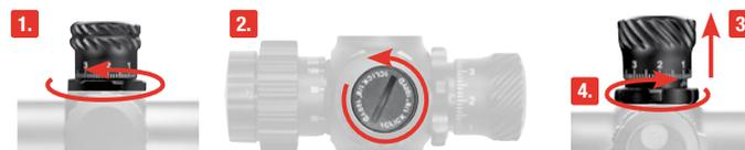
Once the scope has been sighted in, the elevation and windage adjustments can be set to zero. Im eingeschossenen Zustand kann die Höhen- und Seitenverstellung auf "Null" gestellt werden. Si l'arme est réglée, le réglage latéral et en hauteur peut être positionné sur « zéro ». Una vez regulado el alcance, el ajuste lateral y en altura se puede ajustar a "CERO".
