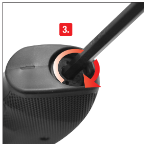
3. Serrer à fond la vis de pression.
