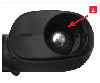
2. CO 2 -Kapsel wie abgebildet einlegen.
