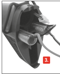
Leitung & Akku wie abgebildet einführen
