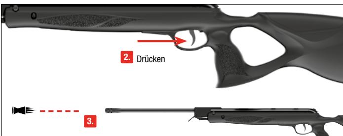
Betätigen Sie nie den Abzug, wenn das Gewehr gespannt und der Lauf abgeknickt ist (Ausnahme - Entspannen, s.o.). Der Lauf würde nach oben schlagen, sich verbiegen und eventuell zu Verletzungen führen! Der Kolben schlägt auf das Spanngestänge und kann brechen. Ebenso kann es zu gerissenen oder gebrochenen Schaft kommen.
