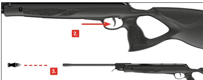
Никогда не нажмите на спусковой крючок, когда винтовка взведена и ствол переломлен (исключение – снятие со взвода, см. выше). Ствол в этом случае отпружинит вверх, деформируется и может привести к травмам! Поршень удалит по рычажному механизму и может поломаться. Может также произойти трещина или поломка приклада.
