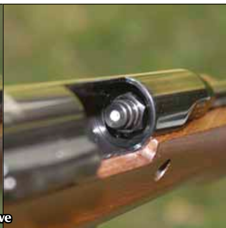
A távcsövet úgy kell felszerelni, hogy a töltőkapu fölé ne nagyon lógjon be
